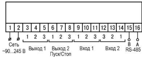
Рисунок 5.2 – Общая схема подключения ТРМ210-Н, -Щ1 и -Щ2
